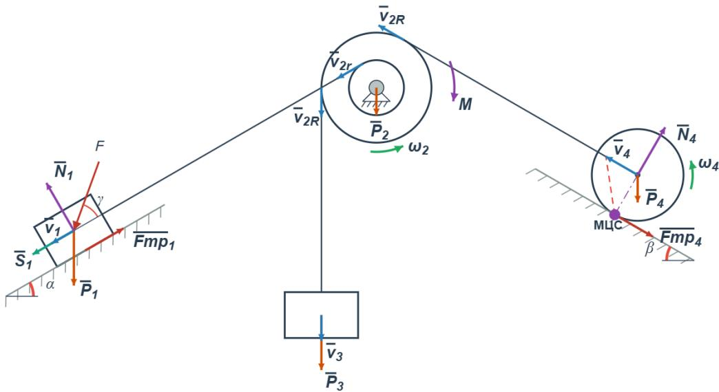
Пользуясь расчетной схемой запишем кинематические соотношения, выразив скорости всех тел через  $V_1$ .
